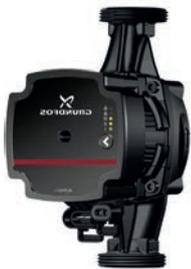
Circulateur de chauffage haut rendement disposant de 3 modes de contrôle : mode chauffage par radiateur, mode chauffage par le sol et courbe constante/vitesse constante. Déblocage manuel.
