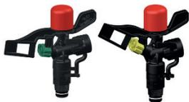
• Asperseur plastique fil 1/2", angle bas 8° ou 28°, buse interchangeable à baïonnette 1/4 de tour, livré avec buse 3,5mm.
