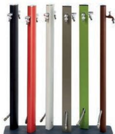
• Bornes jardin aluminium revêtu époxy, hauteur 1,2m, dont 20cm enterrés, entrée à la base fil 1/2", sortie fil 3/4" et raccord auto mâle sur robinet, prévoir fixation par socle vissage 3 points sur dalle, 3 équerres en enterré ou base 45x45x35cm à lester (prévoir galets, béton, sable) enterrée ou à poser. Embase spécifique pour modèle Moon.
