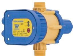
Automate pour le démarrage et l'arrêt la pompe en fonction de l'ouverture ou de la fermeture des robinets avec protection contre le fonctionnement à sec et contre les surintensités.
