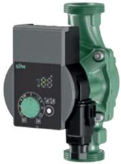
Circulateur de chauffage haut rendement disposant de 3 modes de fonctionnement : pression différentielle constante, pression différentielle variable et vitesse constante (3 courbes caractéristiques de régulation).
