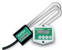
Pour programmeurs 24v uniquement, mesure l'humidité du sol indépendamment de sa température et de sa conductivité ; autorise l'arrosage quand l'humidité du sol est inférieure au seuil réglé, affiche température, conductivité, historique.
