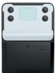
Le VILLA est un programmeur d'arrosage Bluetooth® étanche et sur secteur se connectant directement sur une box Wi-Fi. Il possède un large écran et des boutons pour une lecture facile. Il est capable de programmer en séquentiel des électrovannes 24V. Relié à un compteur d'eau, il permettra de suivre votre consommation d'eau et de recevoir des alertes en temps réel en cas de fuites de sous-débit et sur-débit. Transformateur externe 230V/24VAC
