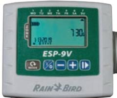
• Grand écran, stations indépendantes ou séquentielles, autonomie 1 an, 2 piles pour 2 ans, borne sonde désactivable, démarrage de pompe ou vanne maîtresse (sur modèles 2-4-6), sauvegarde réglages installateur, mémoire non volatile, IP68, dimensions h13 x l10 x 6cm.
